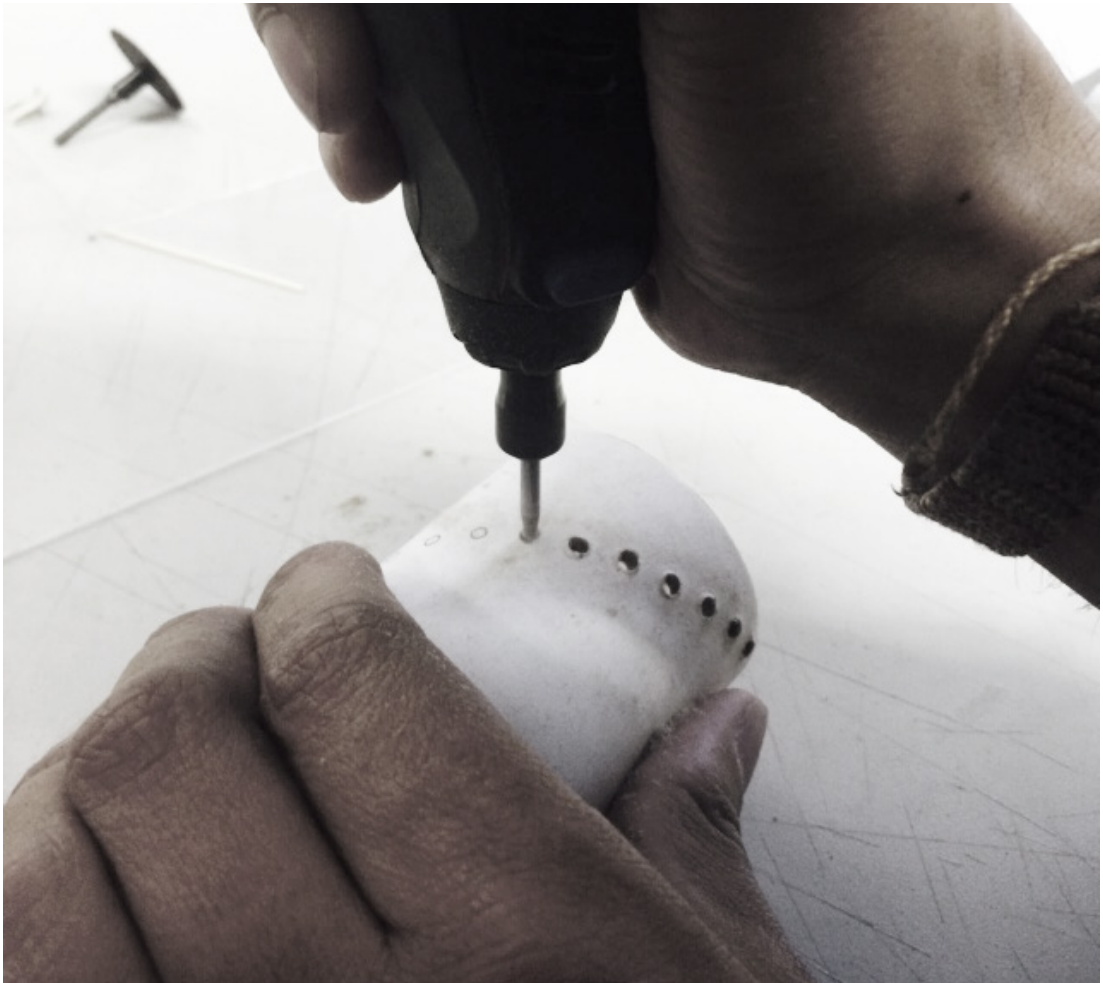
Perforado del palo de agua.
